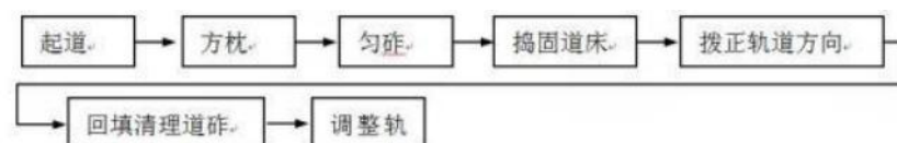
图 2-4 上碴整道施工工艺流程图
